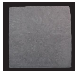
Пруток без трещин, сечение
