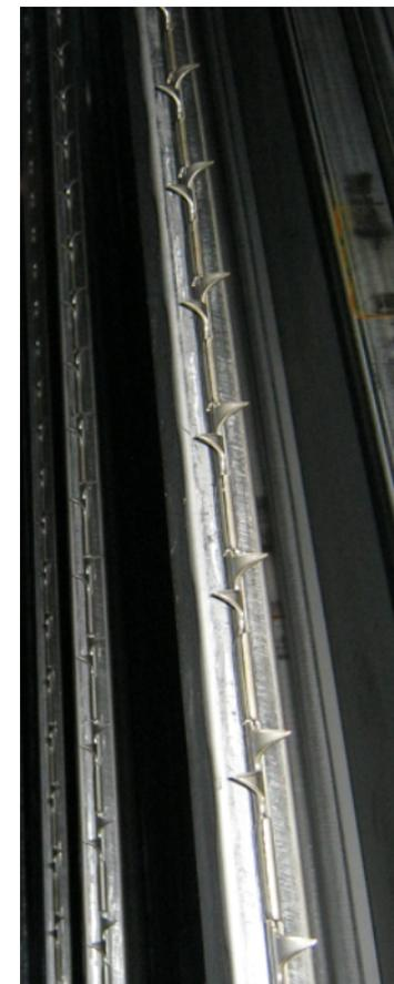
Электроды индивидуально фиксируются таким образом, что противоположный конец свободно может двигаться при тепловой деформации (расширении)
