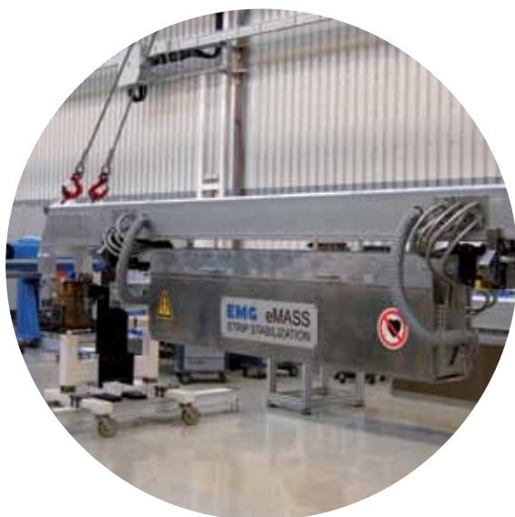
Проверка качества системы eMASS® на заводе EMG
