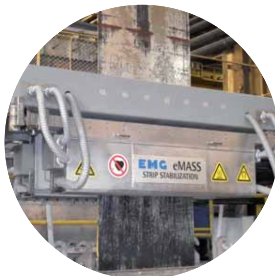
Система, установленная на воздушных ножах линии горячего цинкования
