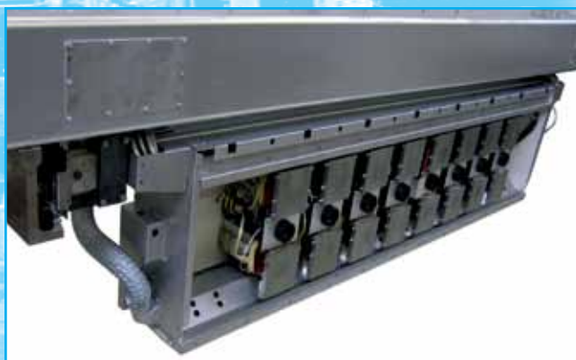
Внутри корпуса: датчики и исполнительные механизмы
